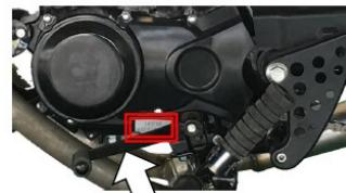
Moottorinumero on stanssattu moottoriin vaihteenvaihtimen alapuolelle.
